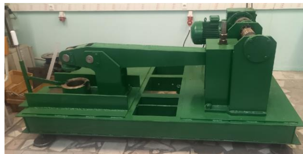
Рис. 1. Стенд циклических испытаний сборных конструкций
