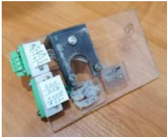
Рис. 6. Кронштейн для датчиков Холла Fig. 6. Bracket for Hall sensors
