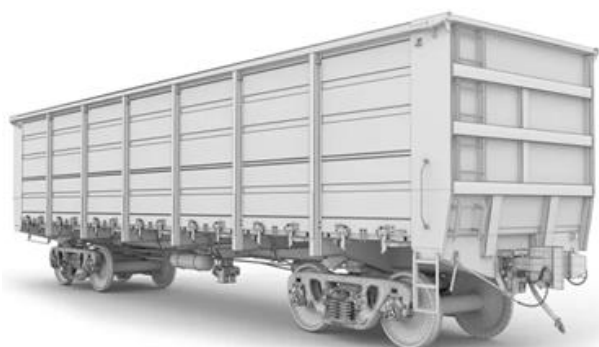
Рис. 4. Модель инновационного полувагона 12-196-02 грузоподъемностью 75 т
