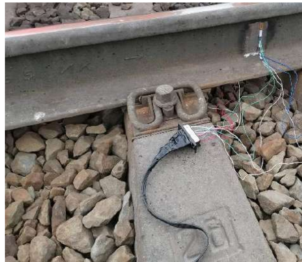
Рис. 3. Схема наклейки тензодатчиков в пути Fig. 3. Load cell sticker diagram on the track
