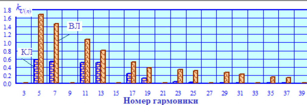
Рис. 13. Спектры гармоник напряжения на шинах 110 кВ ТП 3
