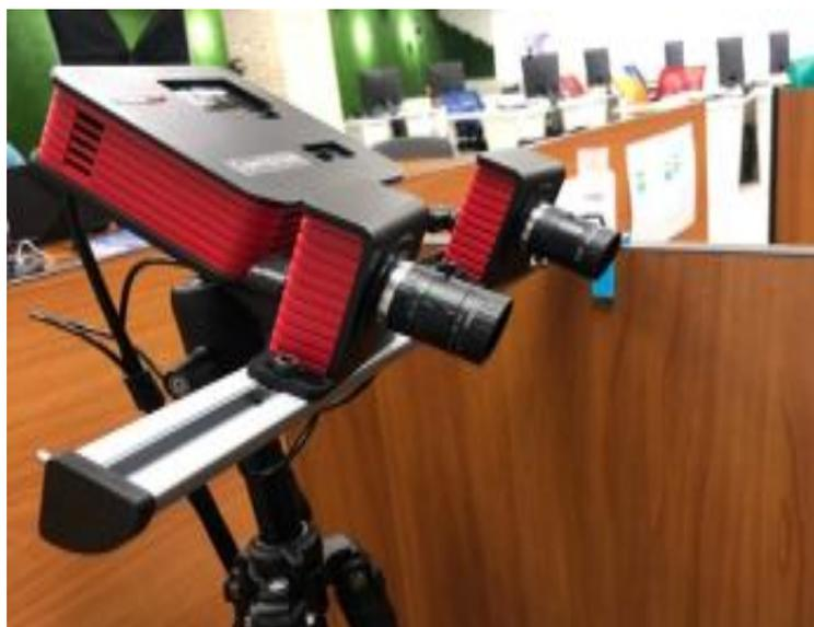
**Рис. 3.** Внешний вид сканера RangeVision Spectrum
