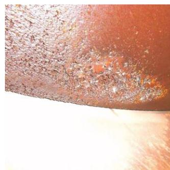
**Рис. 19.** Износ лопаток рабочего колеса в результате кавитации
