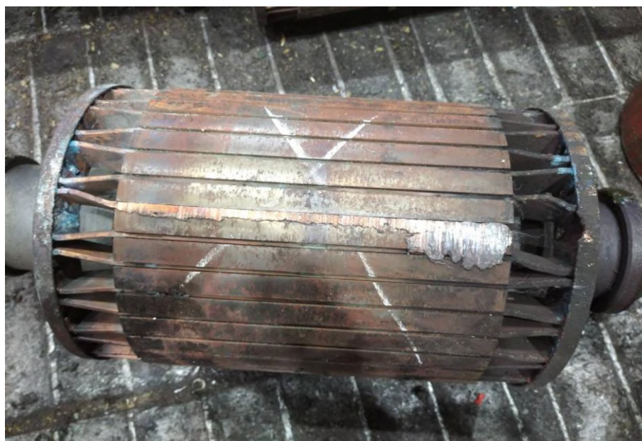
Рис. 2. Подплавление ротора НВА55С
