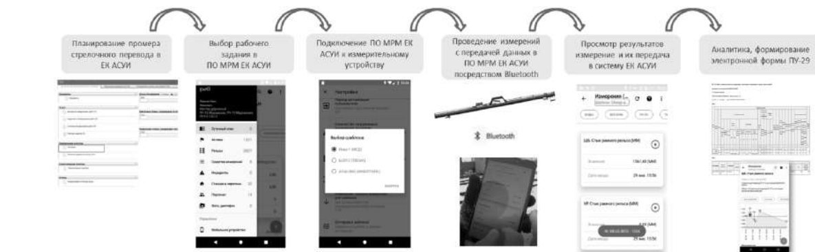
Рис. 7. Схема взаимодействия автоматизированных путевых шаблонов с программным обеспечением мобильного рабочего места Единой корпоративной автоматизированной системы управления инфраструктурой
