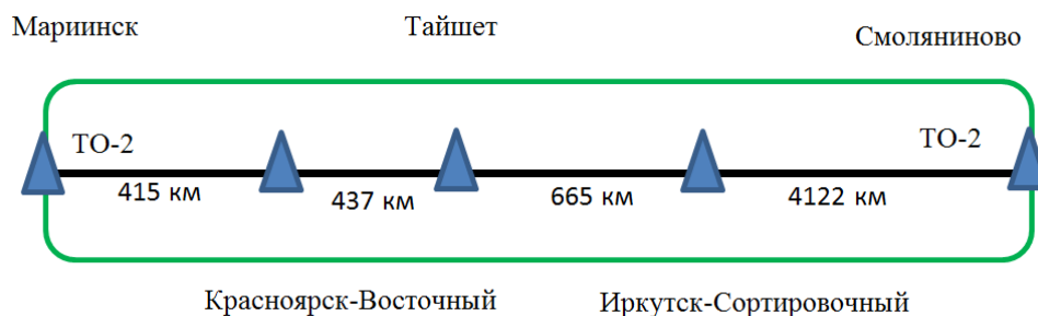
Рис. 6. Участок тягового плеча Мариинск – Смоляниново Fig. 6. A section of the Mariinsk–Smolyaninovo locomotive run
