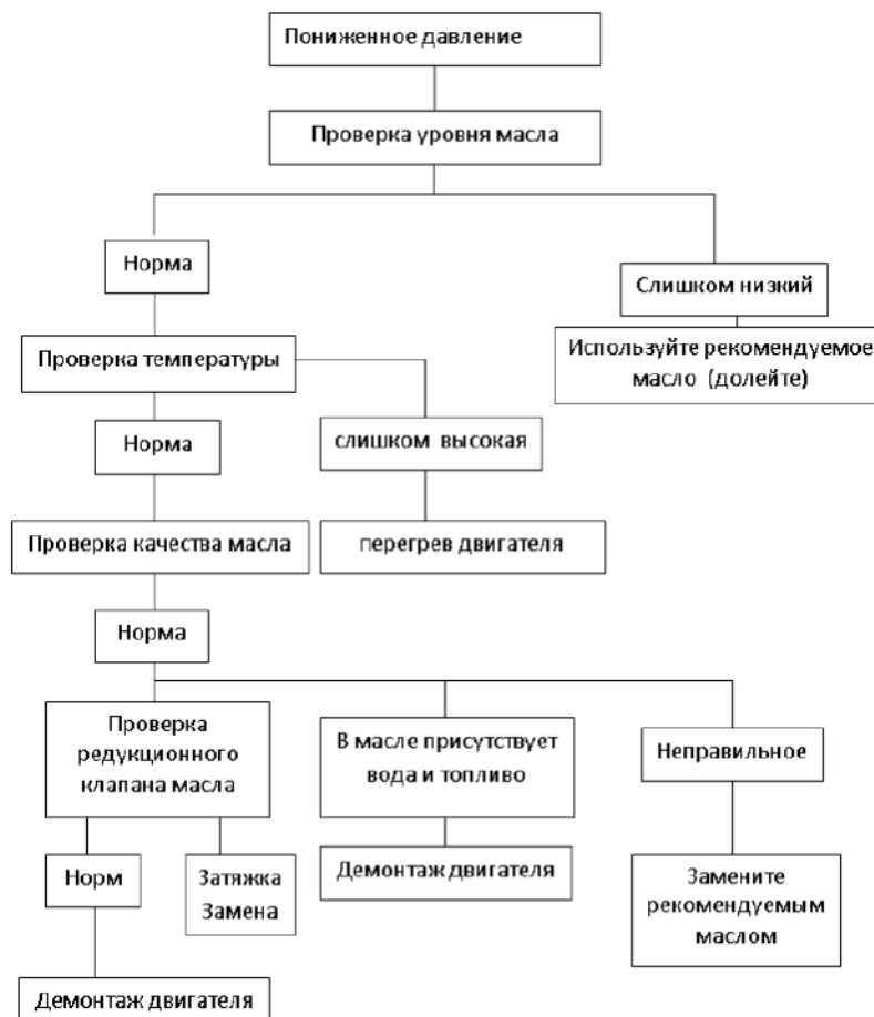
Рис. 7. «Дерево решений» при низкой величине давления масла
