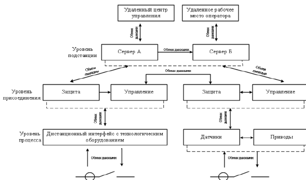
Рис. 1. Структурная схема цифровой тяговой подстанции Fig.1. Structural diagram of a digital traction substation
