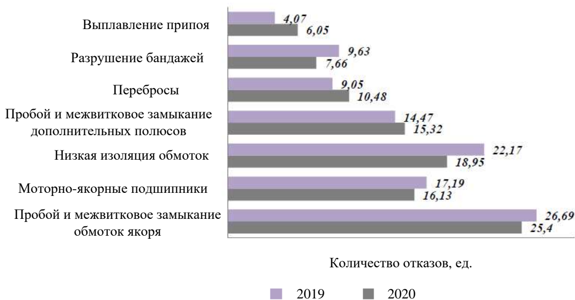
Рис. 2. Причины отказов ТЭД Fig. 2. Reasons for traction electric engine failures
