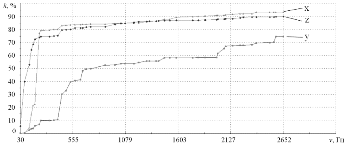
Рис. 8. График зависимости частоты от коэффициента массового участия измененной конструкции Fig. 8. Graph of the dependence of frequency on the mass participation factor of a modified construction design
