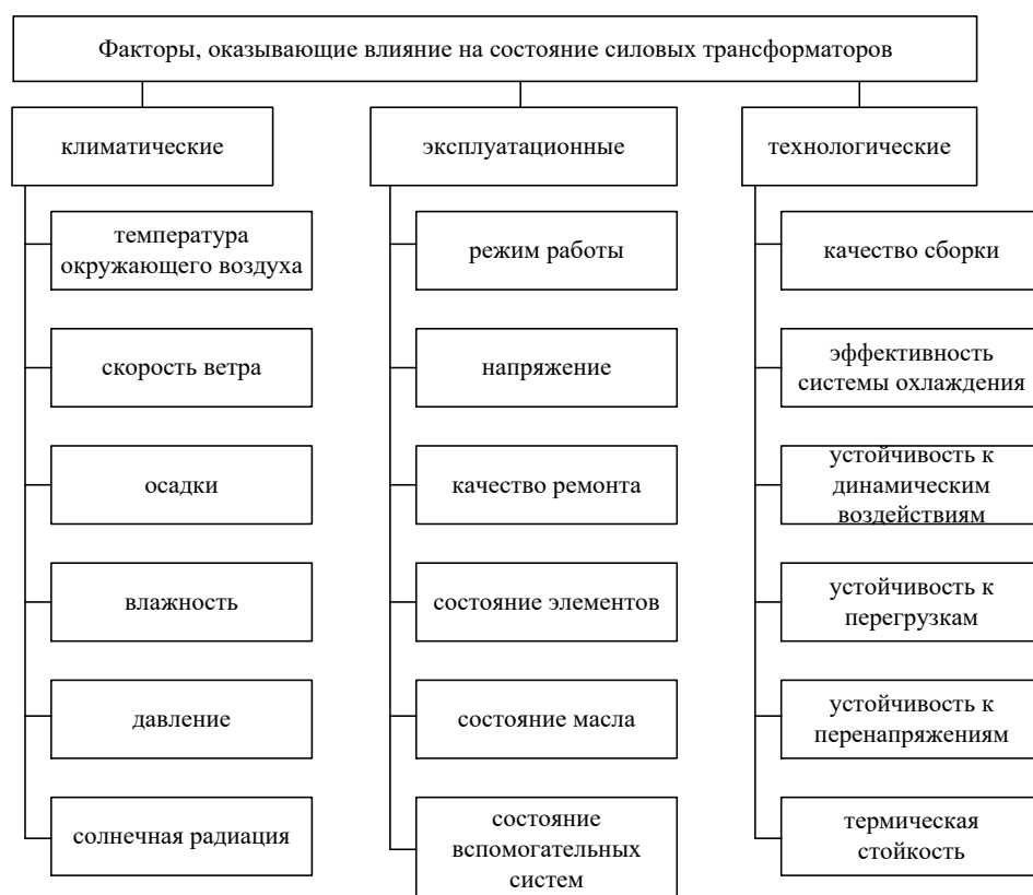
Рис. 1. Факторы, оказывающие влияние на состояние силового трансформатора
