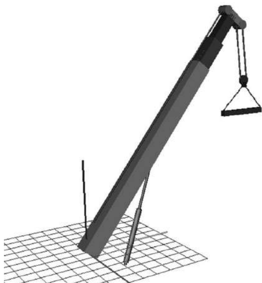
Рис. 1. Компьютерная модель трехсекционной телескопической стрелы
