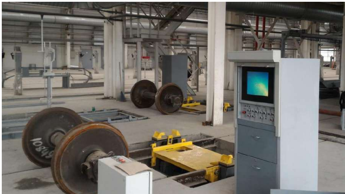
Рис. 2. Система вибродиагностики ОМСД-03
