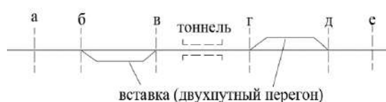
Рис. 9. Схема тоннеля с прилегающими двухпутными перегонами
