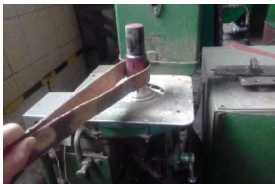
Рис. 1. Станок для шлифовки электроизоляционных пальцев
