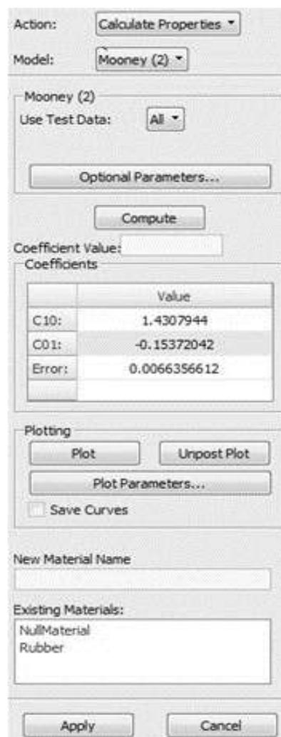
**Рис. 13.** Построение модели Полимерного резиноподобного материала с помощью инструмента MSC.Software Patran Experimental Data Fitting
