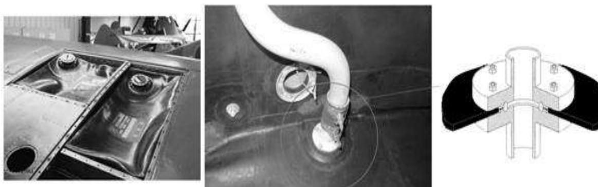
Рис. 1. Фланцевое соединение топливного бака самолета
