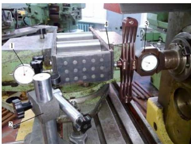
**Рис. 7.** Установка измерения жесткости приспособления:
