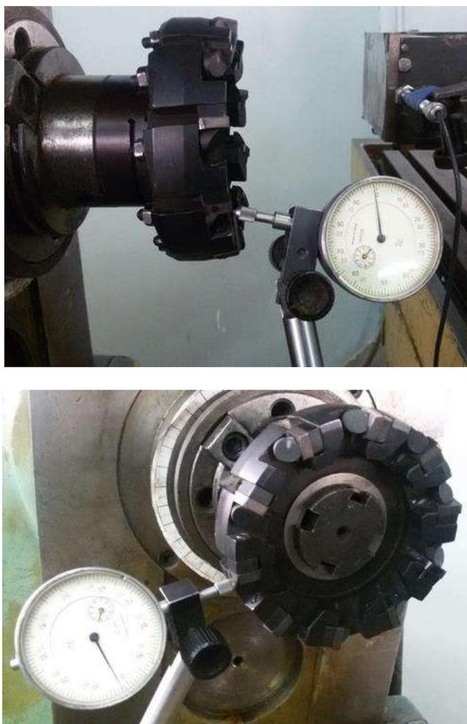
**Рис. 3.** Измерение радиального и торцевого биения зубьев
