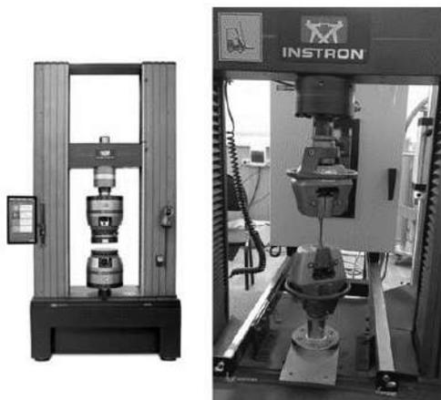
**Рис. 8.** Универсальная электромеханическая испытательная машина INSTRON 5982
