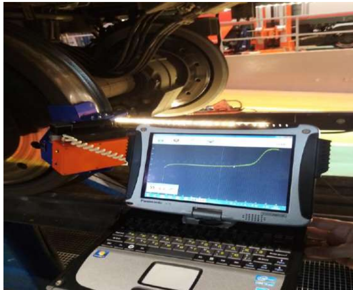
Рис.3. Измерение профиля колеса скоростного поезда «Ласточка» Fig. 3. Measurement of the wheel profile of «Lastochka» high-speed train
