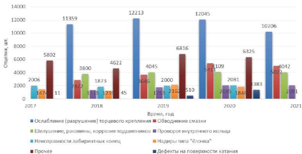
Рис. 5. Отцепки вагонов по неисправностям буксового узла в 2017–2021 гг. Fig. 5. Car uncoupling due to axle box faults in 2017–2021
