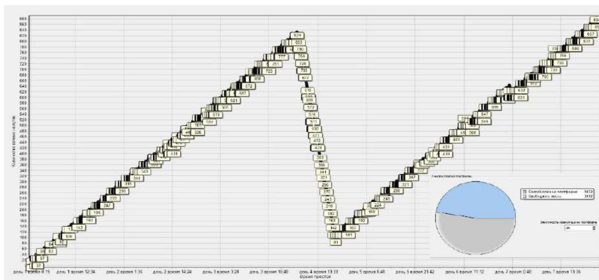
Рис. 5. Результаты имитационного моделирования работы железнодорожной контейнерной площадки транспортного узла Пусан при существующих объемах поступающего вагонопотока
