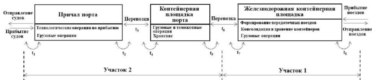
Рис. 4. Технологическая схема работы Пусанского транспортного узла:
