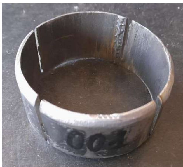
Рис. 7. Фотография детали, деформированной угловой шлифовальной машиной
