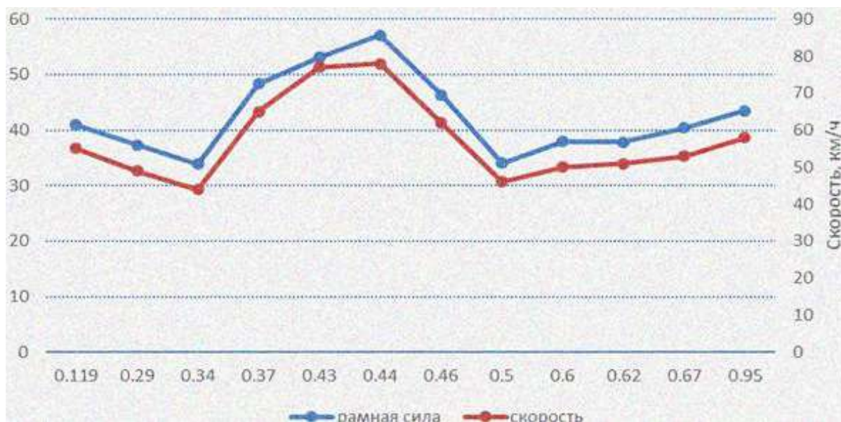
Рис. 4. Взаимосвязь скоростного режима с рамной силой Fig. 4. Relationship between speed and frame strength
