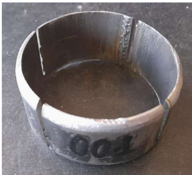
Рис. 7. Фотография детали, деформированной угловой шлифовальной машиной
