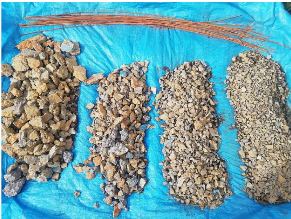
Рис. 4. Дробленный бетон и арматура
