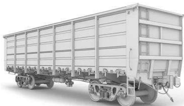
Рис. 4. Модель инновационного полувагона 12-196-02 грузоподъемностью 75 т
