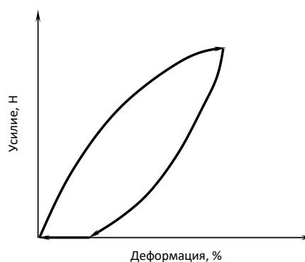
Рис 1. Гистерезисная кривая эластичного амортизатора
