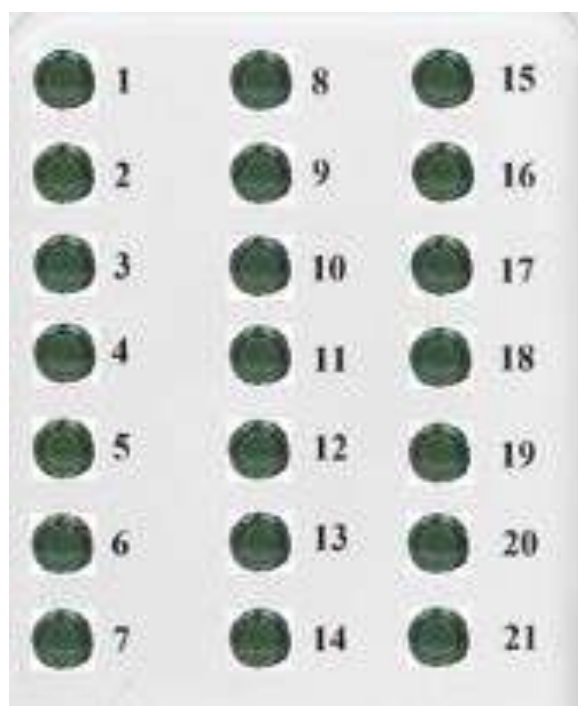
Рис. 4. Расположение многоцветных RGB светодиодов на передней панели приемного полукомплекта устройства диагностики электропневматических тормозов в соответствии с номером вагона в поезде
