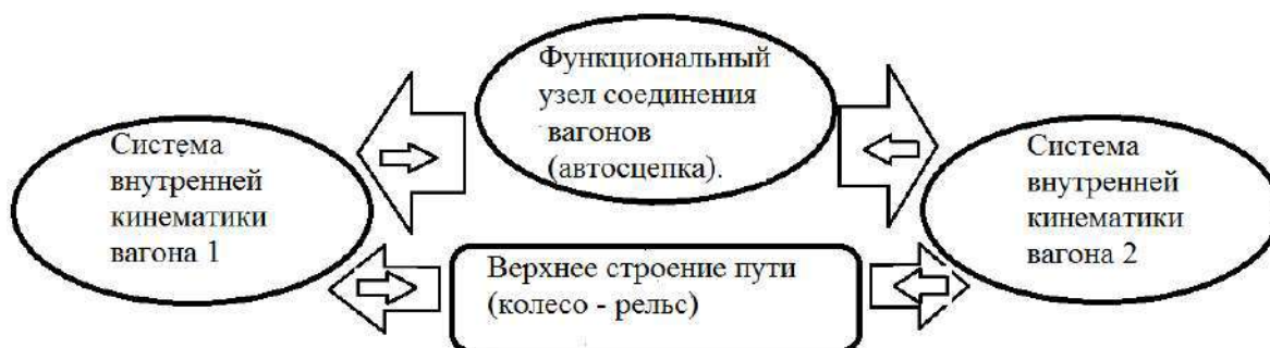
Рис. 1. Схема замкнутой системы внешних механических воздействий на вагон, движущийся в составе поезда Fig.1. Scheme of a closed system of external mechanical influences on a car moving as part of a train
