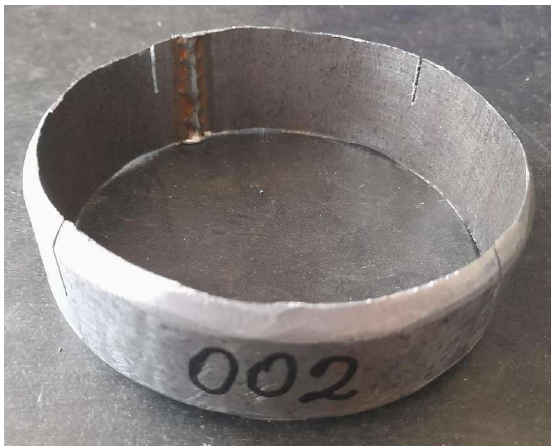
Рис. 5. Фотография детали № 002, деформированной ножовкой по металлу
