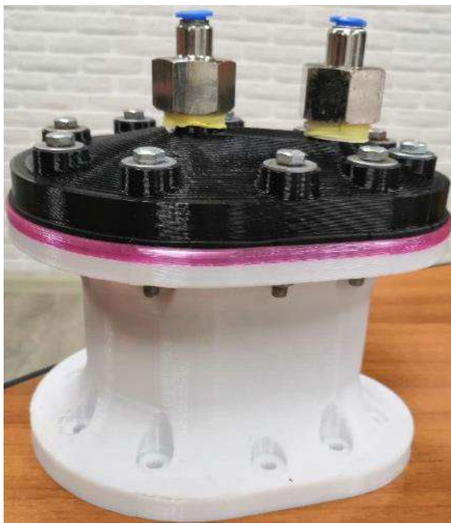
Рис. 9. Модернизированная часть корпуса пневматического редуктора
