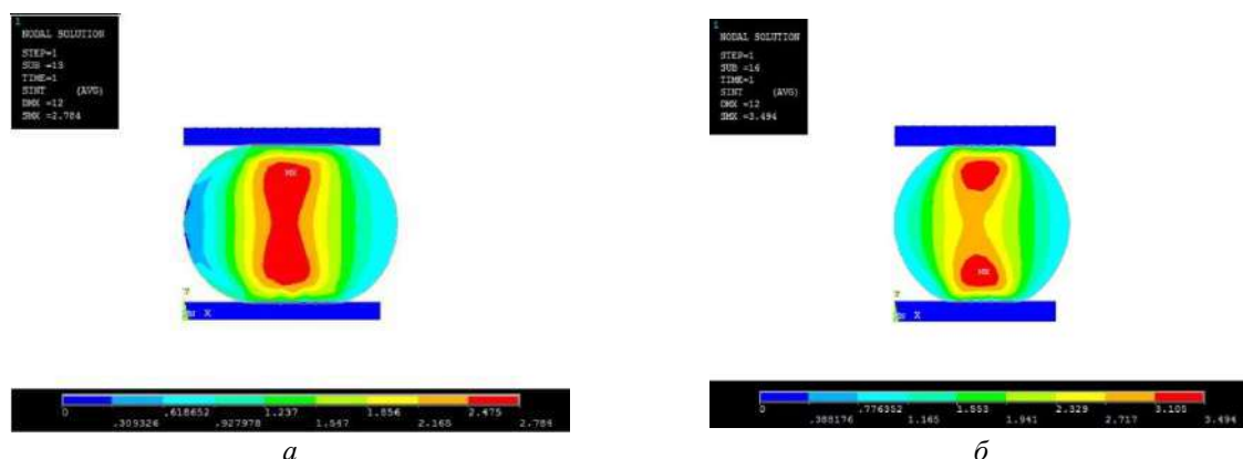
Рис. 7. Эквивалентные напряжения по Мизесу при осевом статическом сжатии эластичного амортизатора:
