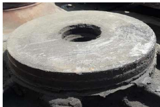
Рис. 8. Пятник с изношенными контактными поверхностями
