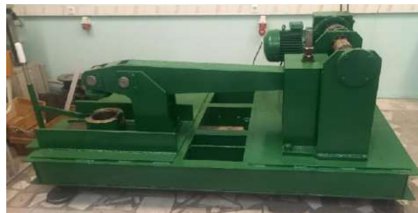
Рис. 1. Стенд циклических испытаний сборных конструкций
