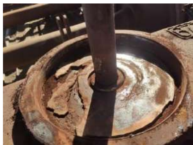
Рис. 10. Изношенный диск Fig. 10. Worn out disk
