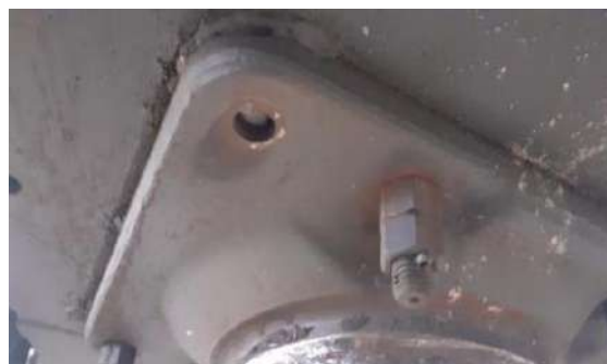
Рис. 9. Обрыв крепежного болта пятника
