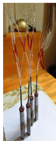
Рис. 3. Изготовление компенсационных датчиков с применением тензорезисторов
