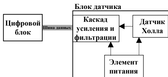
Рис. 1. Структурная схема прибора регистрации напряженности и индукции магнитного поля Fig. 1. Block diagram of the device for registering the intensity and induction of the magnetic field
