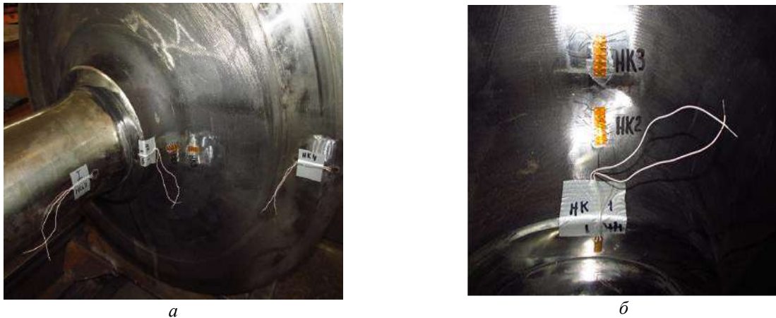
Рис. 5. Наклеивание тензорезисторных датчиков: а – направляющее правое колесо (четыре датчика); б – направляющее левое колесо (три датчика)
