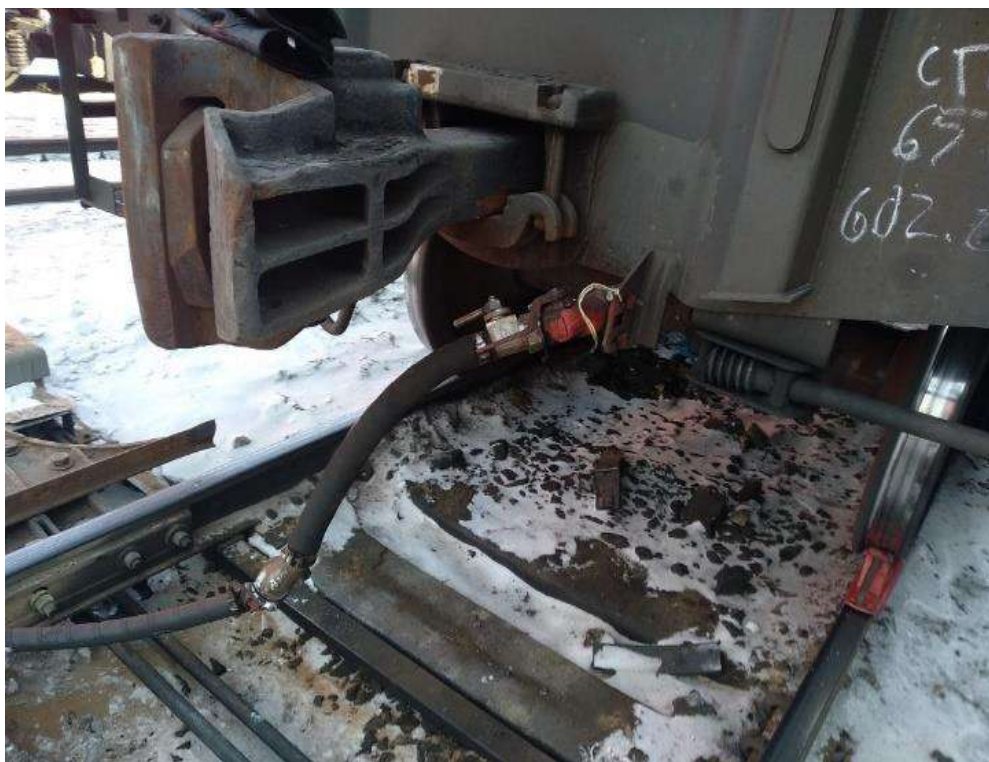
Рис. 2. Фото УКУС-ТМ, установленного на головной вагон состава грузовых вагонов
