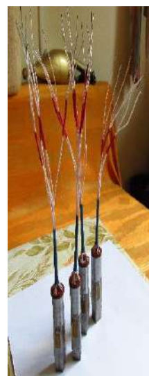
Рис. 3. Изготовление компенсационных датчиков с применением тензорезисторов
