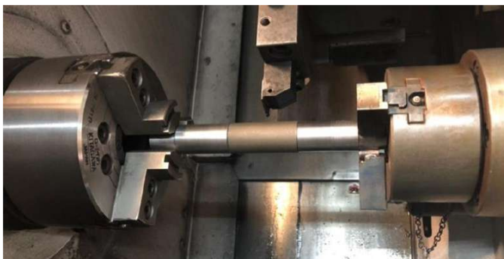
Рис. 1. Схема базирования заготовки Fig. 1. Workpiece basing scheme
