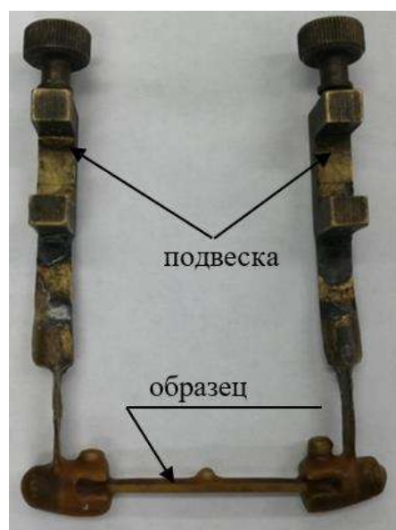
Рис. 7. Исследуемый образец, закрепленный на подвеске Fig. 7. Test sample mounted on a suspension
