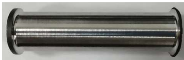
Рис. 2. Втулка после проведения лезвийной обработки Fig. 2. Bushing after machining processing
