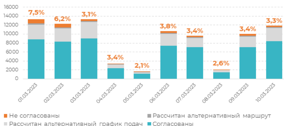
Рис. 3. Итоги согласования заявок ГУ-12 с использованием динамической модели загрузки инфраструктуры
