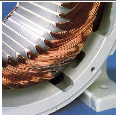
Рис. 7. Межвитковое замыкание Fig. 7. Turn-to-turn short circuit
