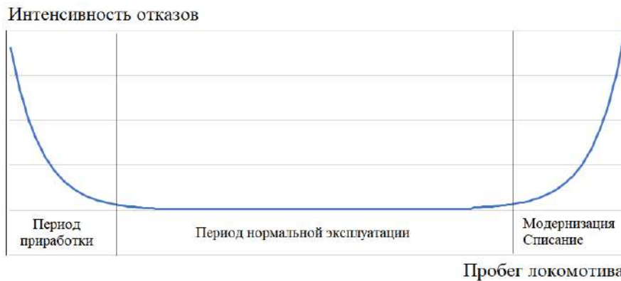
Рис. 3. Изменение интенсивности отказов на жизненном цикле оборудования
