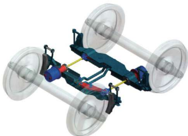
Рис. 1. Унифицированная рычажная передача грузовых четырехосных вагонов Fig. 1. Unified lever transmission of four-axle freight wagons
