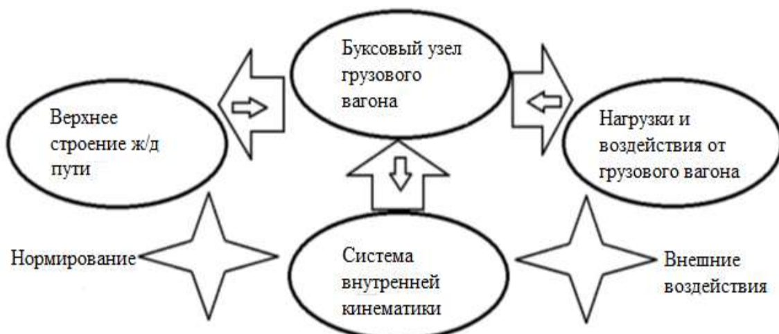
Рис. 2. Схема силового взаимодействия буксового узла грузового вагона
