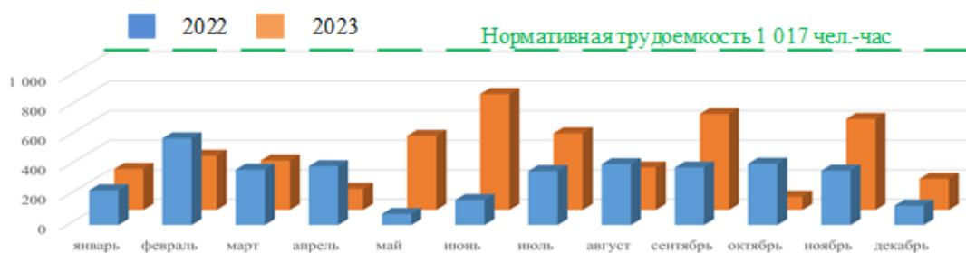
**Рис. 4.** Трудоемкость обслуживания устройств участка (нерегламентные работы)
