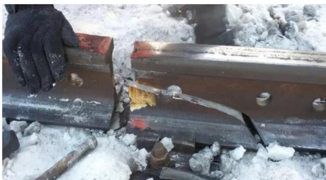
Рис. 9. Последствия вертикального уступа
