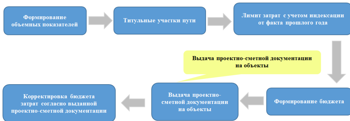
Рис. 1. Схема планирования капитального ремонта пути до внедрения калькулирования затрат Fig. 1. The scheme of planning the overhaul of the path before the introduction of cost calculation
