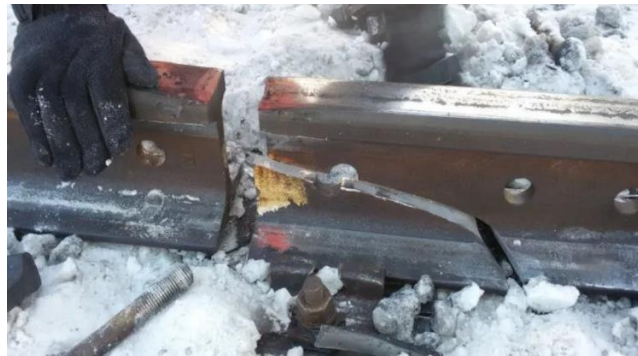
Рис. 9. Последствия вертикального уступа Fig. 9. Consequences of vertical ledge
