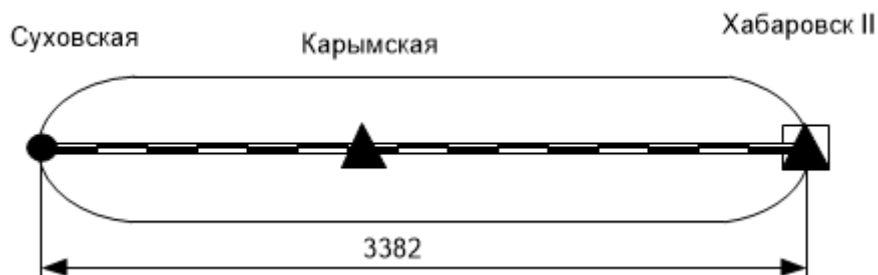
Рис. 4. Схема тяговых плеч на участке Суховская – Хабаровск-II Fig. 4. Scheme of traction arms on the Sukhovskaya – Khabarovsk-II section
