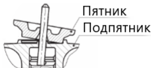
Рис. 9. Принцип работы участков узла «пятник – подпятник» при наклонах
