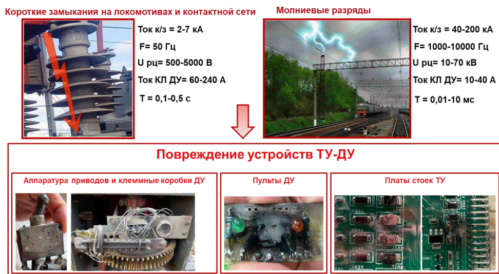
Рис. 1. Электрические параметры, сопровождающие повреждения устройств теледистанционного управления
