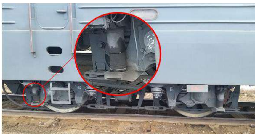
Рис. 4. Электровоз серии 3ЭС5К № 128 ( а ) и потекшие гидравлические гасители колебаний ( б ) Fig. 4. 3ES5K series electric locomotive No 128 and leaking hydraulic vibration dampers
