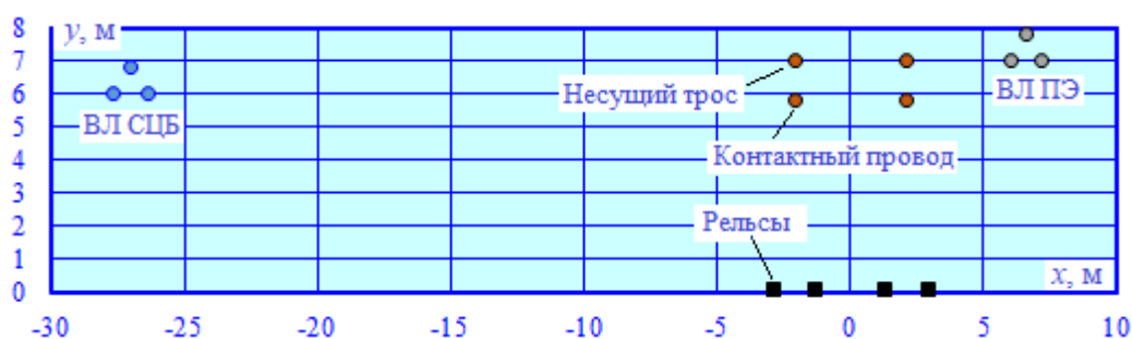
Рис. 3. Расположение токоведущих частей Fig. 3. Location of live parts
