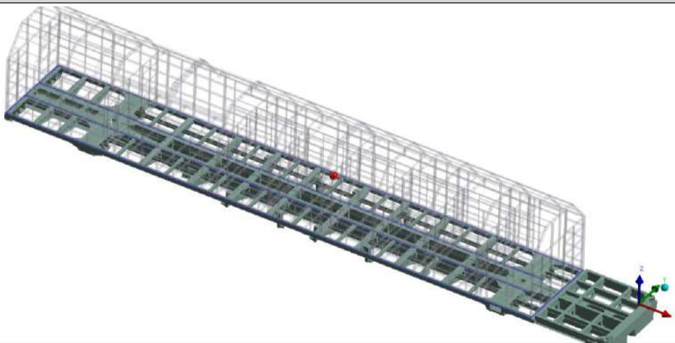
Рис. 6. Соединение главной рамы с каркасом кузова Fig. 6. Connection of the underframe with the body frame
