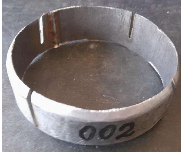
Рис. 11. Фотография детали № 002, деформированной болгаркой Fig. 11. Photograph of a part deformed by an angle grinder
