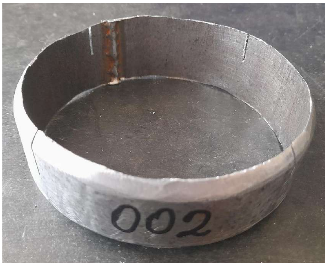
Рис. 5. Фотография детали № 002, деформированной ножовкой по металлу
