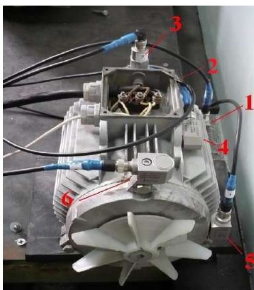
Рис. 10. Экспериментальные исследования пространственной вибрации асинхронного электродвигателя АИР90L4УЗ:
