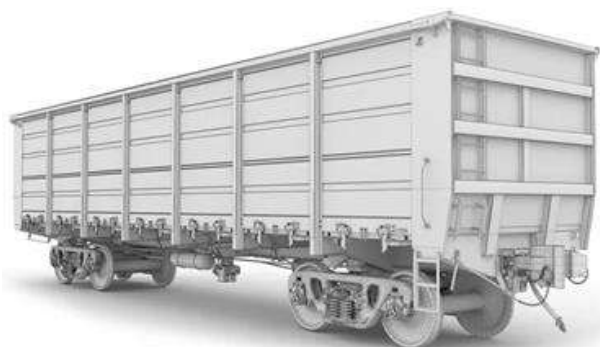
Рис. 4. Модель инновационного полувагона 12-196-02 грузоподъемностью 75 т
