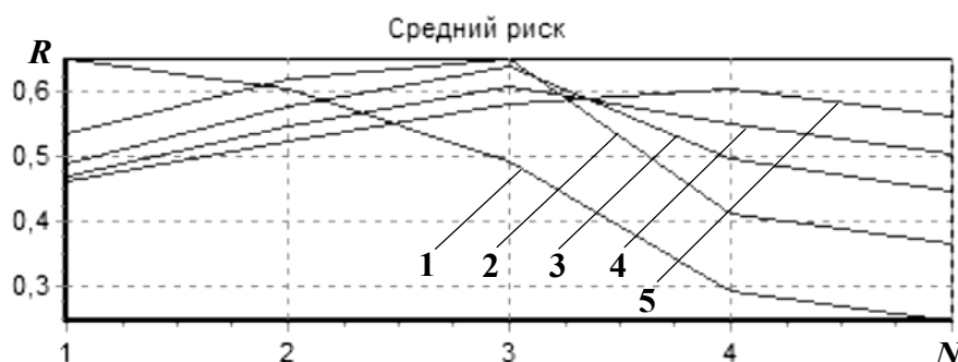
Рис. 7. Изменение вероятности среднего риска по годам эксплуатации с учетом стоимости пропуска дефекта C_{12} :
