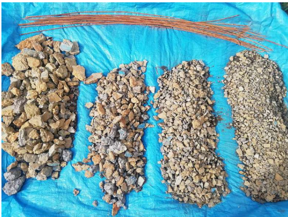
Рис. 4. Дробленный бетон и арматура
