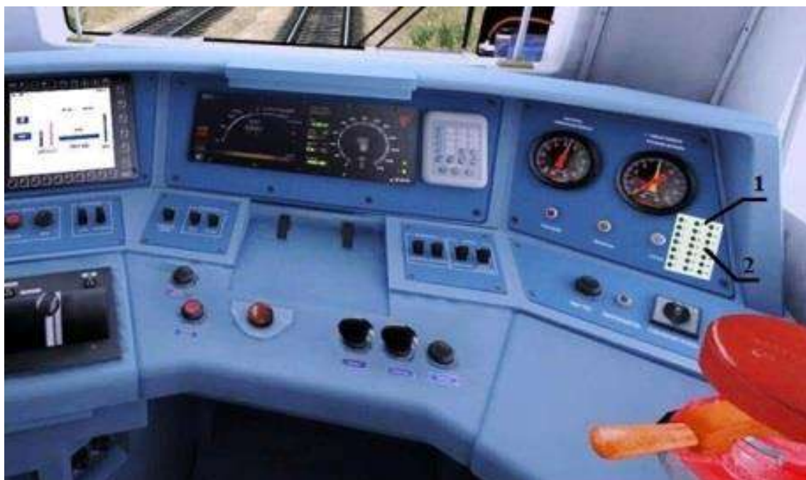
Рис. 5. Расположение приемного полукомплекта устройства диагностики электропневматических тормозов:
