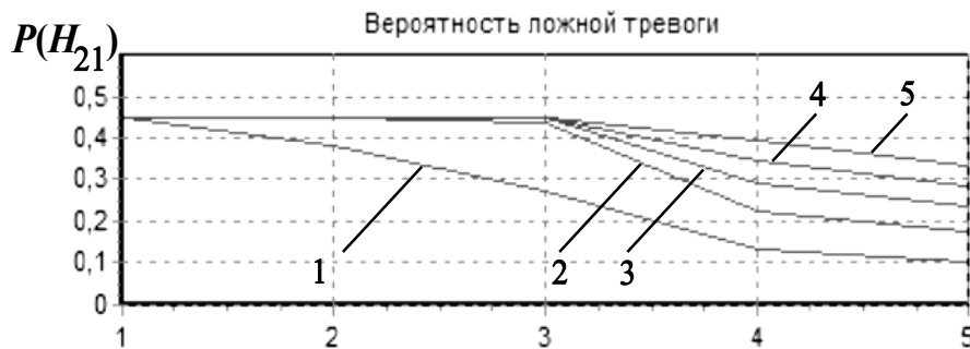
Рис. 5. Изменение вероятности ложной тревоги по годам эксплуатации в зависимости от стоимости пропуска дефекта C_{12} :
