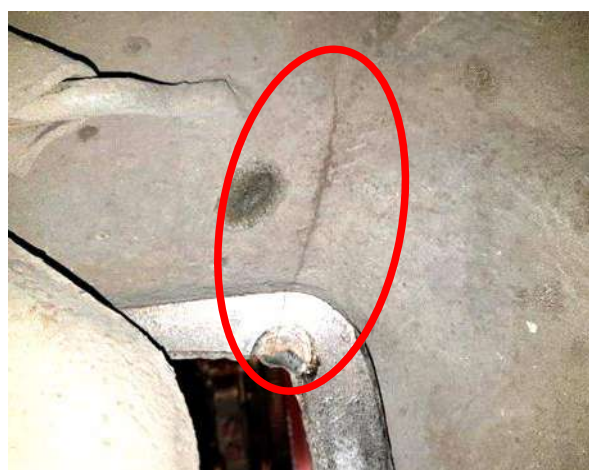
Рис. 3. Трещины в остове тягового электродвигателя НБ-514:
